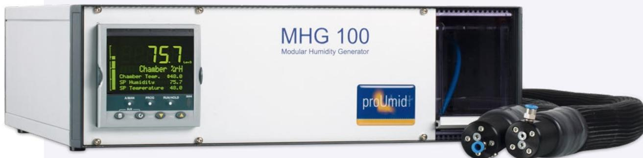
Leistungsfähiger Feuchtgenerator für die Befeuchtung von größeren Volumen. Die Luftfeuchterege- lung in einer geschlossenen Regelschleife mit Temperatur geregelten Zuleitungen ermöglicht die präzise Einstellung der relativen Feuchte auch bei hohen Durchflussraten.
