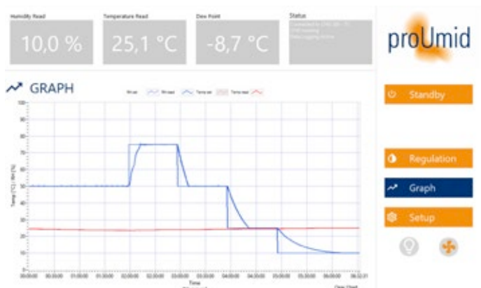
Feuchteregeleung einer 500 l Glovebox mit der CHG Control-Software
