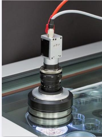
Die Kameraoption für die SPS Geräte ermöglicht Bildaufnahmen zur Dokumentation visueller Veränderungen der Proben während einer Sorptionsmessung.
