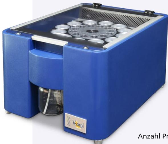
Vollautomatisches Multiproben Sorptionsprüfsystem für die gravimetrische Wasserdampfsorption. Zur Bestimmung der Sorptions- und Desorptionsisotherme sowie der Sorptionskinetik im erweiterten Bereich der Raumtemperatur und über einen weiten Bereich der relativen Luftfeuchte.
