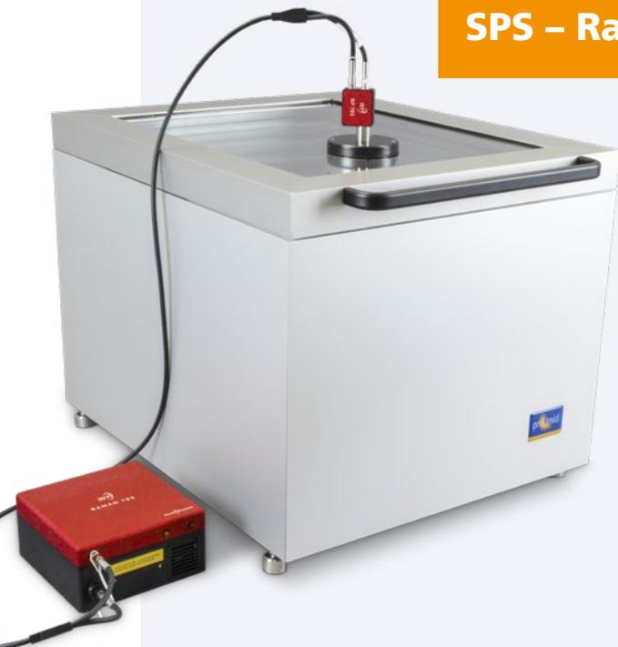
Die Kombination der dynamischen Wasserdampfsorption mit Raman Spektroskopie erweitert die analytischen Möglichkeiten der SPS Systeme und eröffnet neue Perspektiven für die Analyse von Feststoffen.
