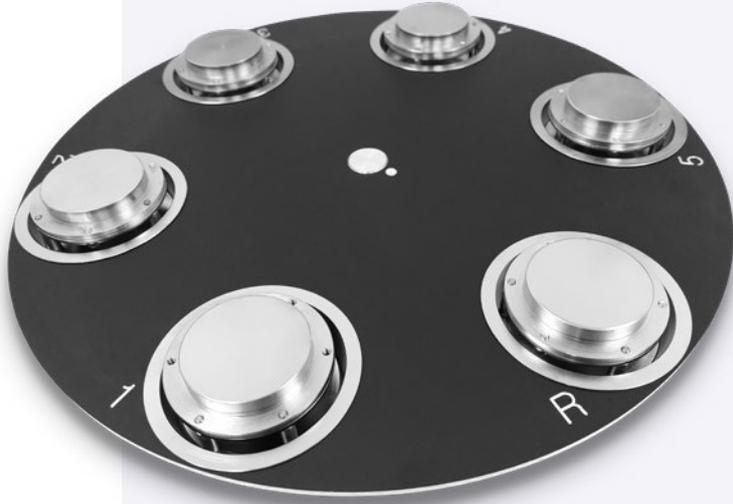
Zur gravimetrischen Bestimmung der Dampfdurchlässigkeit von Folien und Filmen mit den SPS und Vsorp Systemen.
